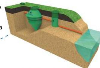
Монтаж очистного сооружения типа NV с инфильтрацией в грунт
