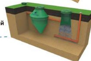
Монтаж очистного сооружения типа NV с насыпной инфильтрацией при высоких грунтовых водах
